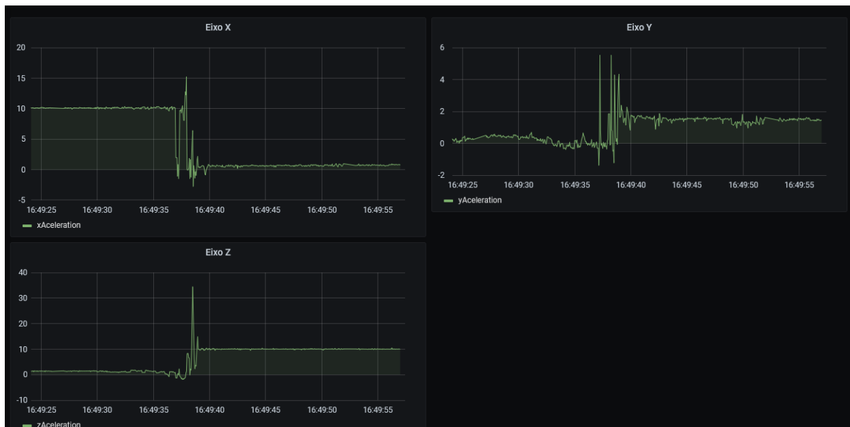
Figura 5.8: Sinais da aceleração em função do tempo para o evento “queda para trás” (em m/s^2 ). Nos eixos das abscissas temos o horário da coleta dos dados e nos eixos das ordenadas temos a aceleração em m/s^2 .
