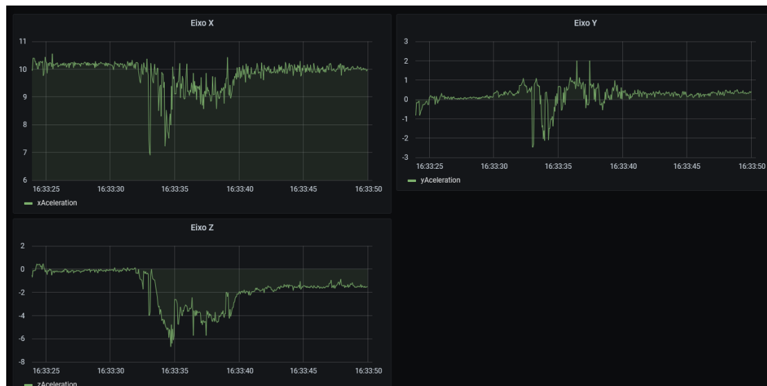
Figura 5.6: Sinais da aceleração em função do tempo para o evento “agachar” (em m/s^2 ). Nos eixos das abscissas temos o horário da coleta dos dados e nos eixos das ordenadas temos a aceleração em m/s^2 .
