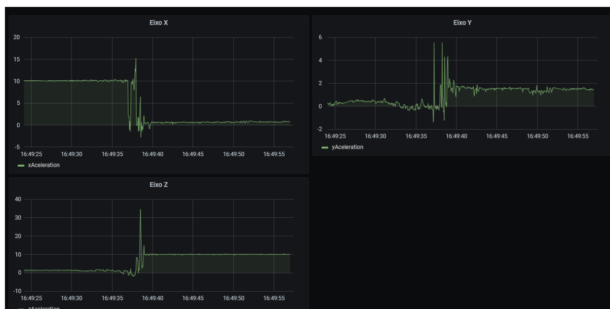
Figura 4.10: Sinais da aceleração em função do tempo para o evento “queda para trás” (em m/s^2 ). Nos eixos das abscissas temos o horário da coleta dos dados e nos eixos das ordenadas temos a aceleração em m/s^2 .
