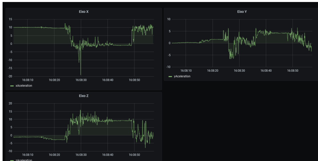
Figura 5.3: Sinais da aceleração em função do tempo para o evento “deitar” (em \text{m/s}^2 ). Nos eixos das abscissas temos o horário da coleta dos dados e nos eixos das ordenadas temos a aceleração em \text{m/s}^2 .
