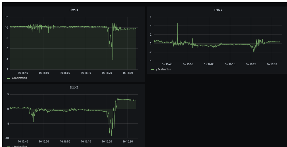
Figura 5.2: Sinais da aceleração em função do tempo para o evento “sentar” (em m/s^2 ). Nos eixos das abscissas temos o horário da coleta dos dados e nos eixos das ordenadas temos a aceleração em m/s^2 .
