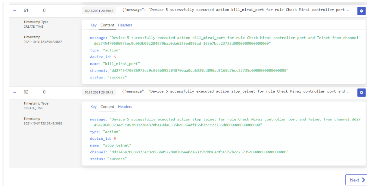
Figura 4.20 – Relatório de execução da ação da regra para detecção do Mirai fornecida pelo agente externo
