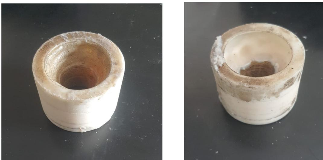
Figura 28 – Grão após o primeiro teste e o quarto teste, do lado esquerdo para a direita, respectivamente
