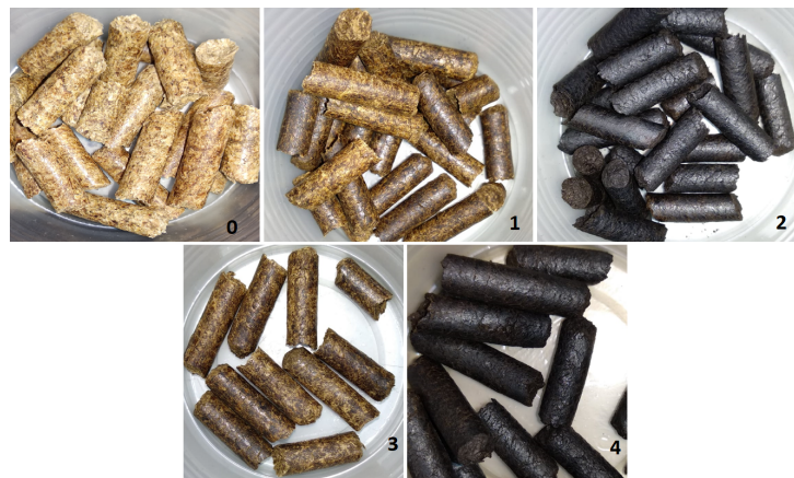
Figura 48 – Biomassa em in natura (0) e após torrefação.
