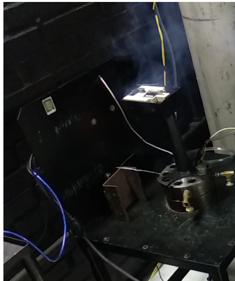
Figura 52 – Gases expelidos pelo sistema de aquisição de massa durante ensaio de teste.
