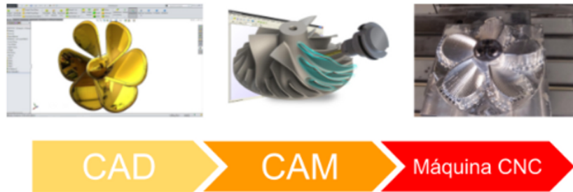
Figura 9.11: Processo de design e manufatura por usinagem CNC de um hélice [137]
