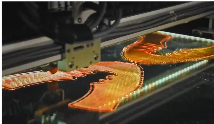
Figura 8 - Representação da fabricação de um cabedal por meio de impressão 3D, produção do calçado Nike Zoom Vaporfly Elite Flyprint. Fonte: (NIKE, 2018)
