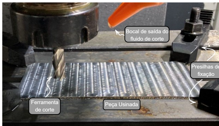
Figura 73 – Chapa obtida após usinagem da parede fabricada por manufatura aditiva.
