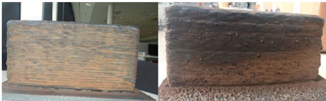
Figura 24 – Corpos de prova utilizados no experimento. Método PAW à esquerda e GMAW à direita (ARTAZA et al., 2019).
