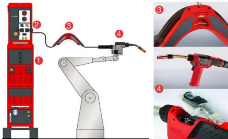
Figura 12 – Componentes básicos de um sistema CMT: 1 – fonte de Alimentação; 2 – cabeçote alimentador; 3 – buffer de arame; 4 – tocha (MARQUES, 2017).
