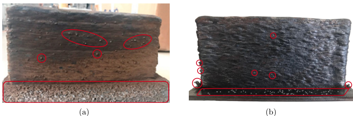
Figura 68 – a) Grande presença de respingos na parede e substrato obtido pelo processo GMAW convencional (adaptado de Artaza et al. (2019)); b) Presença reduzida de respingos obtida pelo processo CMT (imagem do autor).
