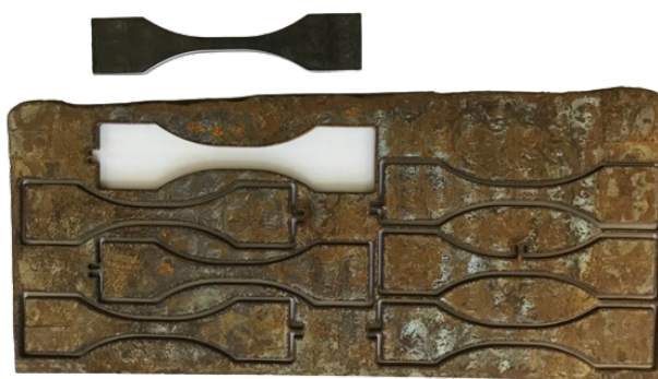
Figura 75 – Comparação entre o CP1 após limpeza superficial com os demais corpos de prova.
