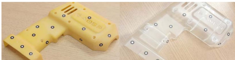
Figura 32 – Modelos desenvolvidos por diferentes métodos: manufatura aditiva, à esquerda, e manufatura subtrativa, à direita (NISHIMURA et al., 2016).
