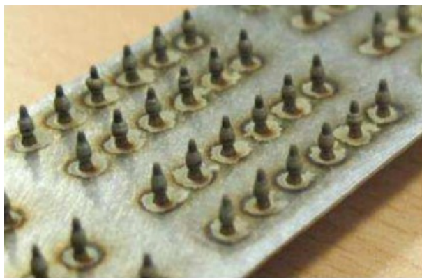
Figura 11 – Pinos fabricados pelo método CMT (STELZER; UCSNIK; PINTER, 2016).
