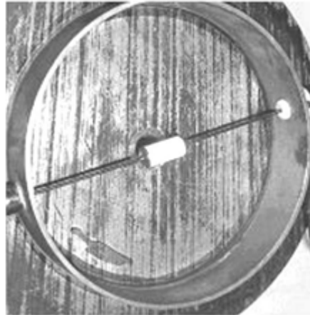
Figura 4.18 – Absorvedor dinâmico adaptativo proposto por Tiseo et al (2010)
