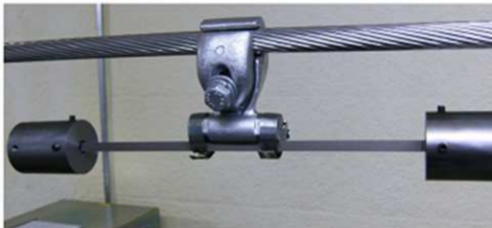
Figura 5.1 – Stockbridge com elemento de SMA em um cabo de transmissão. Cachuté & Yamamoto (2009)
