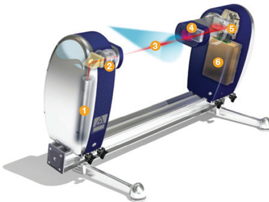
Figura 2.13 – Spraytec Optical System: (1) fonte de laser hélio-neon, (2) lente de colimação, (3) zona de medição, (4) lentes convexas, (5) conjunto detector de diodo de silício, (6) sistema de aquisição rápida de dados (Malvern, 2011).
