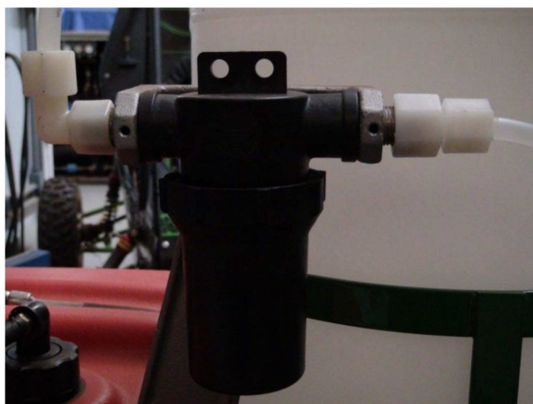
Figura 3.12 – Filtro na linha de defensivo.
