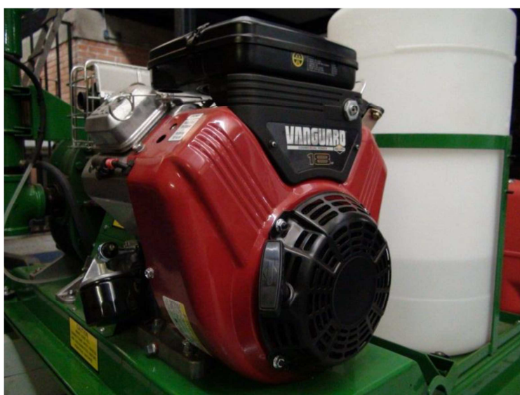
Figura 3.2 – Motor Vanguard™ V-Twin 18HP.
