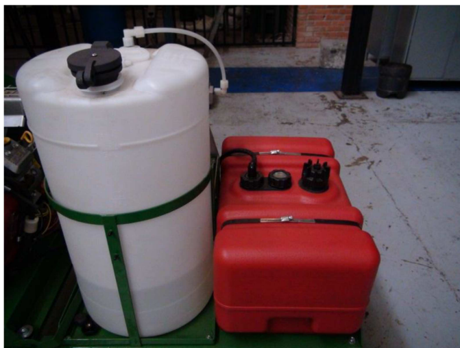
Figura 3.11 – Reservatórios de combustível e defensivo.
