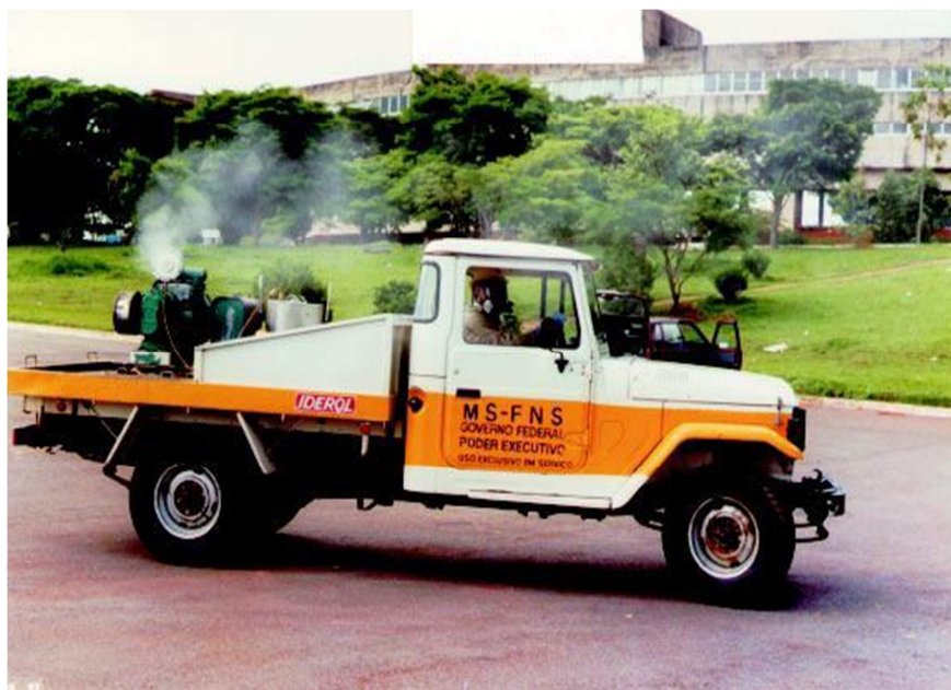
Figura 2.3 – Equipamento UBV pesado montado sobre veículo (FUNASA, 2001).
