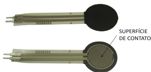
Figura 4.6: Sensor de pressão resistivo FSR 402 [40] (Com adaptações).
