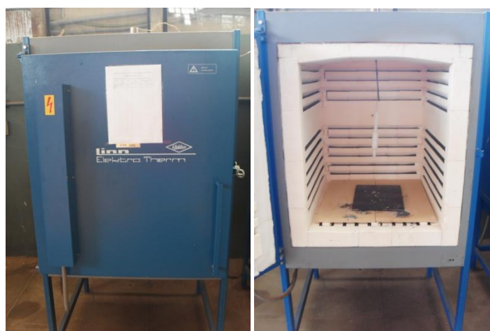
Figura 5.4: Forno da Electro Therm , de temperatura máxima de 1500°.
