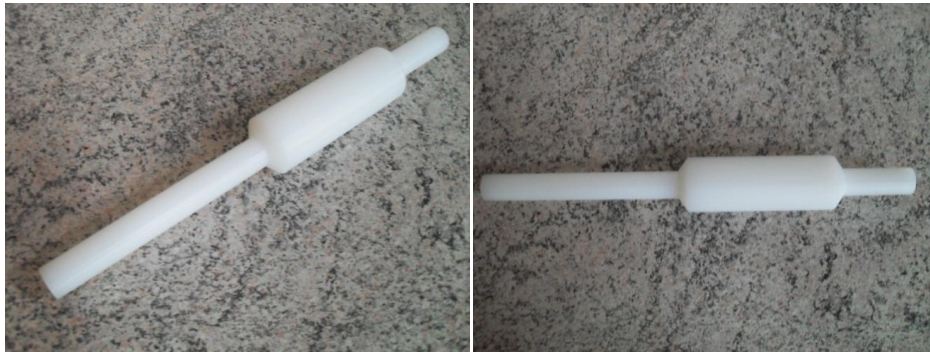
Figura 5.2: Molde do tipo 1 fabricado em tecnil.
