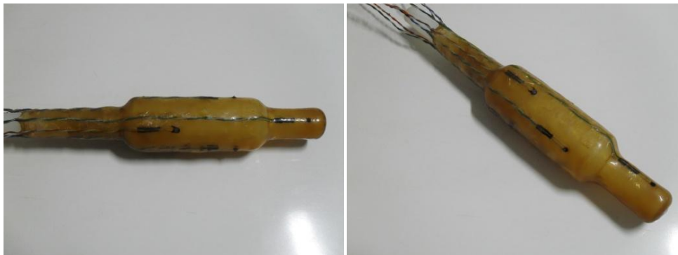
Figura 5.13: Cateter confeccionado com os termistores (sensores de temperatura).
