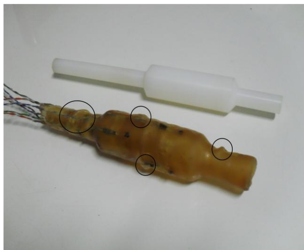
Figura 5.14: Cateter com sensores de temperatura depois de retirado do molde de tecnil (ao lado).
