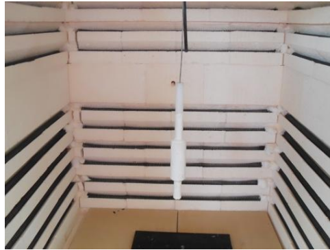
Figura 5.9: Molde na posição vertical dentro forno para vulcanização.
