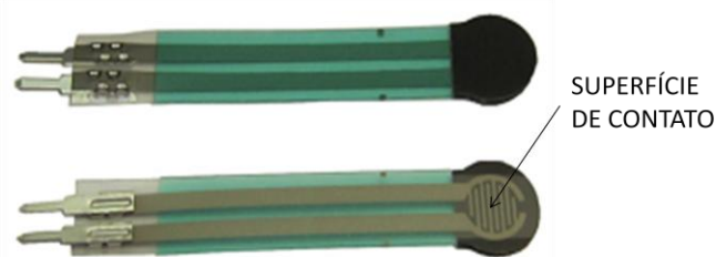
Figura 4.7: Sensor de pressão resistivo FSR 400 [40] (Com adaptações).
