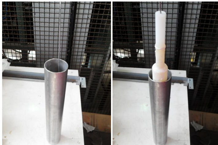
Figura 5.6: Recipiente contendo látex com molde de tecnil imerso.
