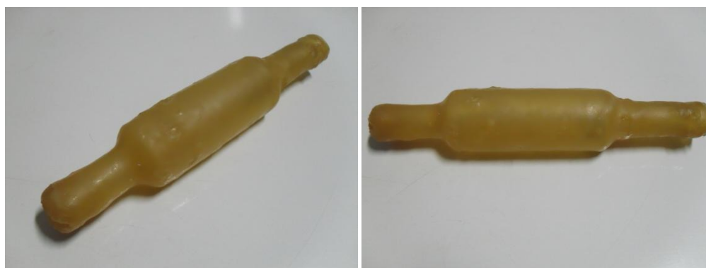
Figura 5.8: Cateter de teste, composto por nove camadas de látex vulcanizado.
