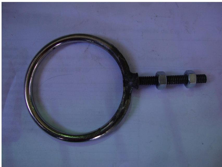
Figura 4.7 – Dispositivo de segurança *Safety Guard*
