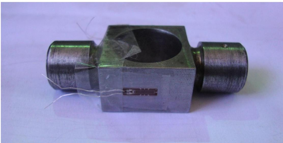
Figura 5.7 – Célula de carga utilizada no projeto
