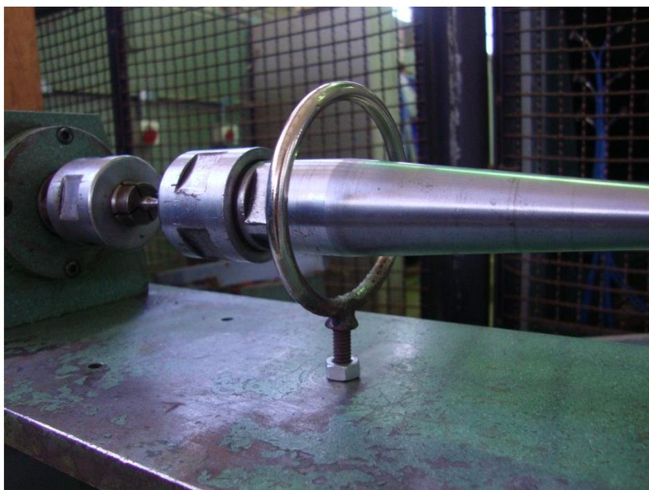
Figura 5.3 – Dispositivo de segurança *Safety Guard* instalado
