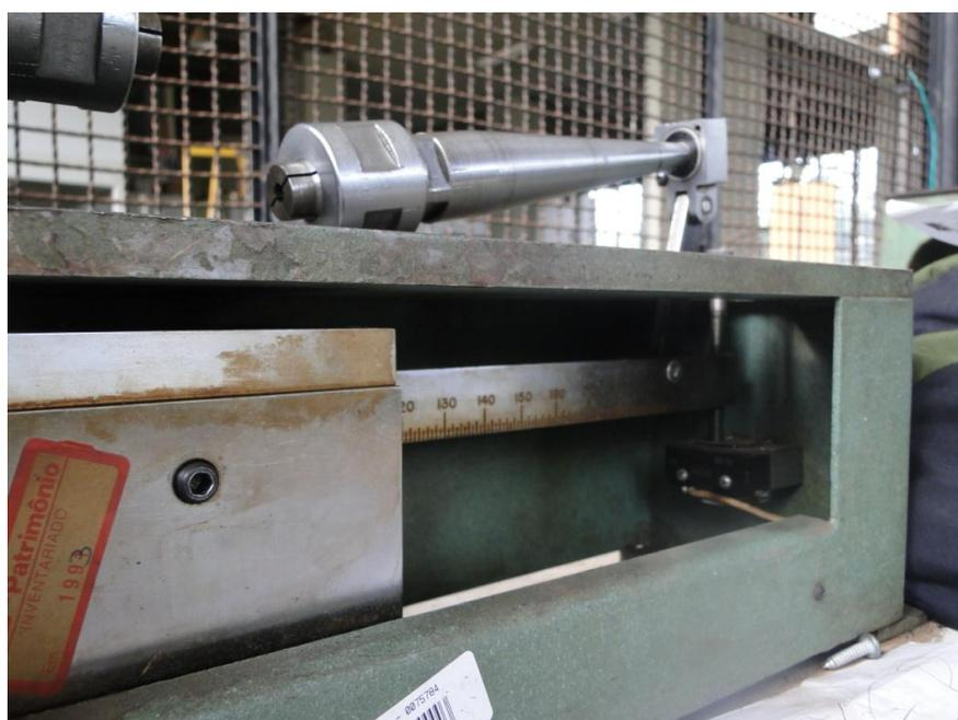
Figura 4.8: Dispositivo de segurança corta-corrente
