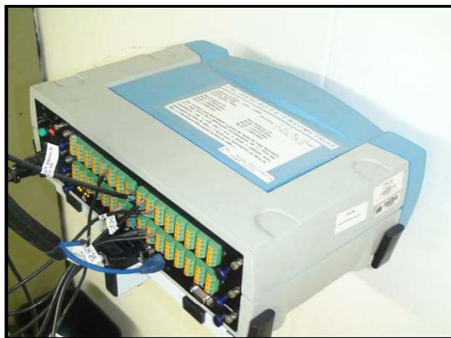
Figura 5.17 – Sistema de Aquisição de dados ADS-2000, Lynx tecnologia.
