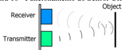
Figura 10 - Funcionamento do Sensor Ultrassônico.
