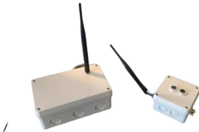
Figura 22 - Solução Criada pela Universidade de Aalborg, contendo Sensor e Gateway .
