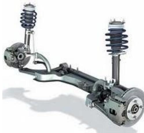
**Figura 3.3: Sistema de suspensão “eixo rígido” (movidosagasolina, 2011)**
