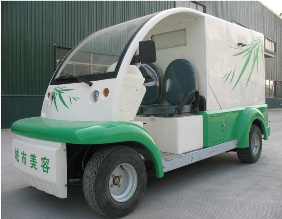
**Figura 1.2: Veículo elétrico para coleta de lixo (Alibaba, 2011)**
