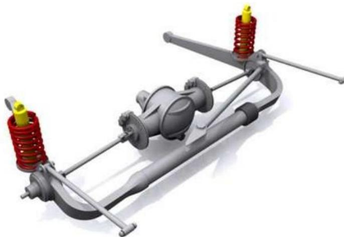
**Figura 3.6: Sistema Eixo De Dion (Bestcars, 2011)**
