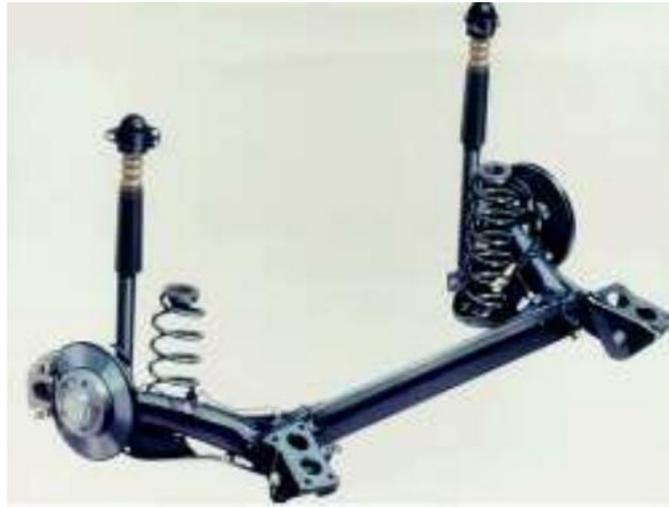
**Figura 3.14: Sistema “Braço de torção” (autotomar, 2011)**
