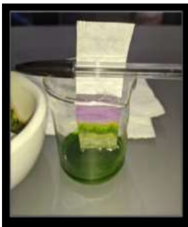
Figura 5. Resultado obtido da Cromatografia em papel.
