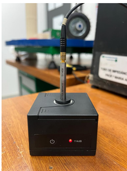
Figura 46 – Calibração dos Microfones
