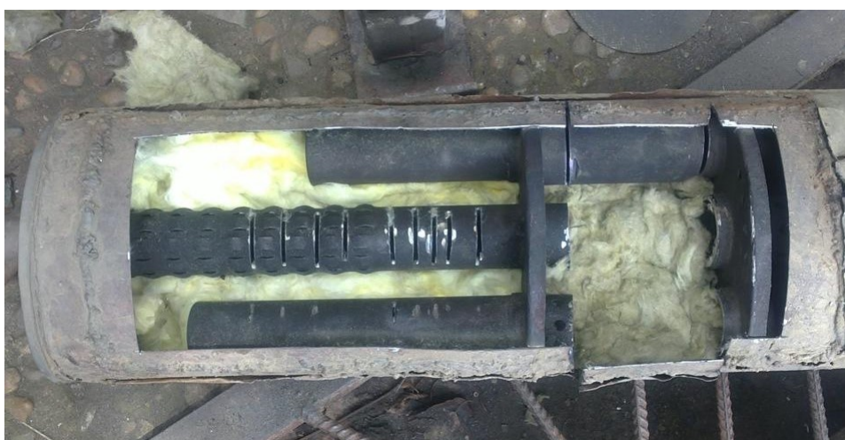
Figura 25 – Filtro acústico híbrido. Fonte: Wiki Mufflers
