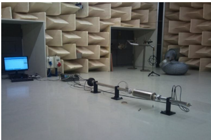
Figura 13 – Método experimental de determinação da TL em uma sala anecoica. Fonte: Rajadurai, Raj e Kumar (2015) .
