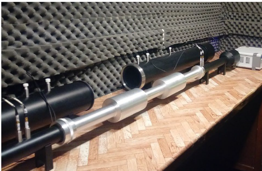
Figura 15 – Configuração experimental para medição da TL de silenciador usando tubo de impedância. Fonte: Damyar et al. (2021) .
