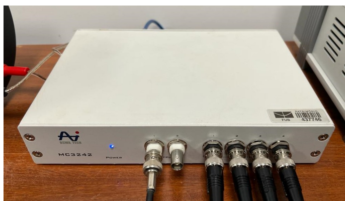
Figura 45 – Analisador de frequência digital de quatro canais utilizado na bancada experimental.
