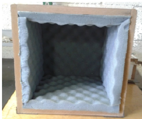
Figura 33 – Caixa Acústica usada para montagem da fonte sonora. Fonte: Silva e Nunes (2013)
