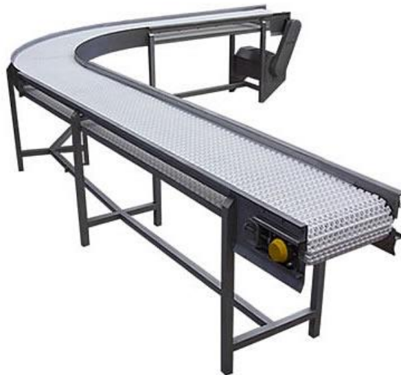
Figura 10 - Imagem ilustrativa da esteira utilizada para mover as caixas Fonte: Montemil, (2022).
