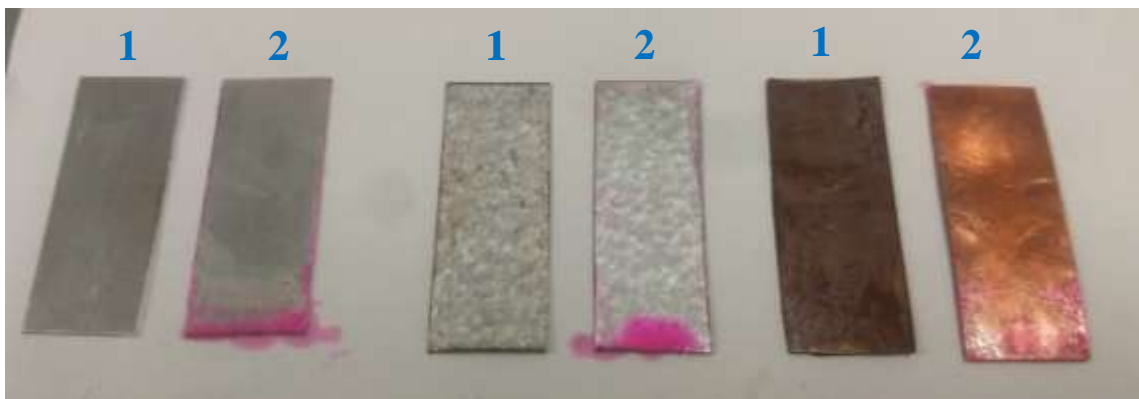
Figura 29: Placas Metálicas após o processo de corrosão (Autoria Própria)
