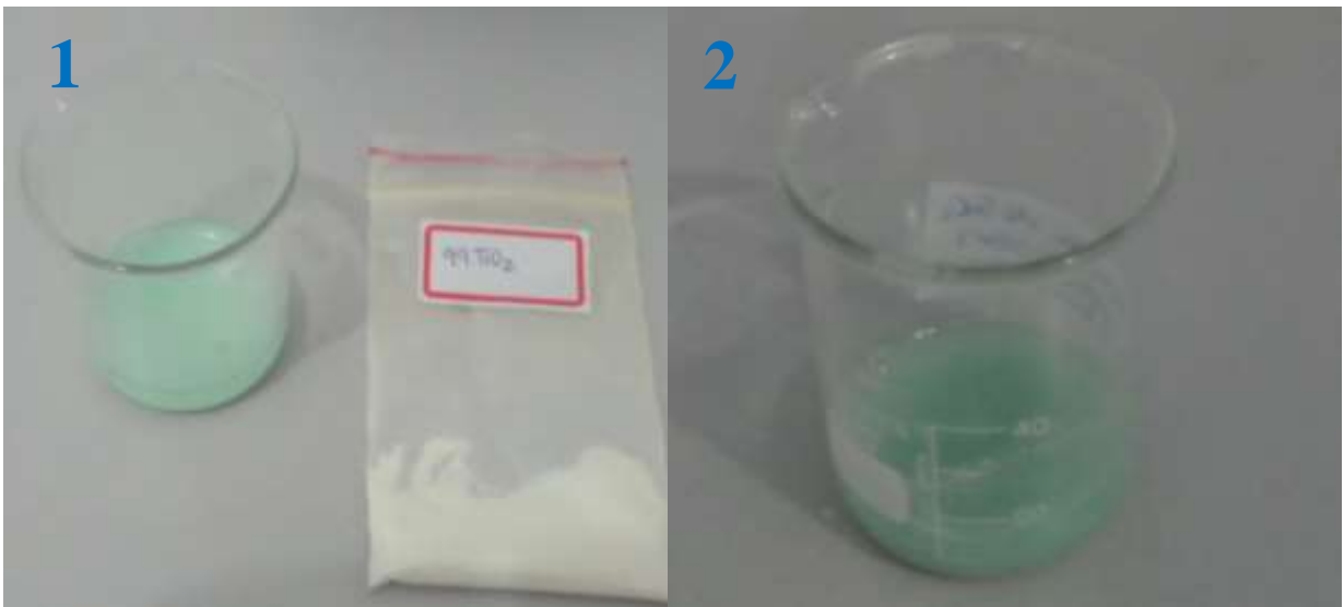
Figura 15: Mistura de Acetato de Níquel com Óxido de Titânio (1) e Óxido de Alumínio (2) (Autoria Própria)
