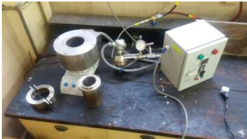
Figura 31: Reator para Hidrogenólise – Equipamento (Cedido pelo professor Montoya)
