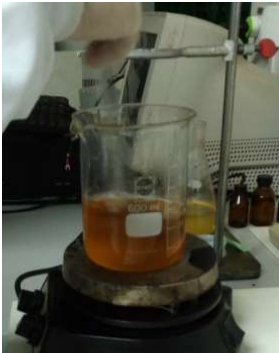
Figura 14: Agitação da Mistura Óleo + Metanol + Hidróxido de Potássio (Autoria Própria)
