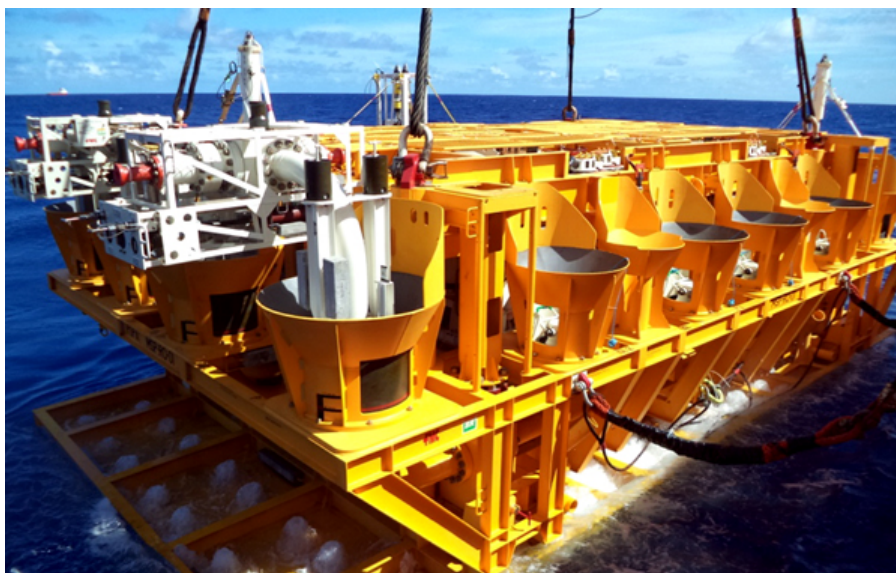
Figura 5 – Manifold Marinho. Fonte: (PETROBRAS, 2018)
