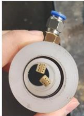
Figura 28 – Bicos Injetores instalados na Conexão de Nylon
