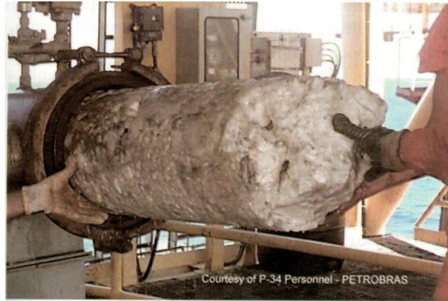
Figura 6 – Pluge de hidrato no receptor de FIG. (Banco de Imagem da Petrobras) Fonte: (ANDREOLLI, 2016)
