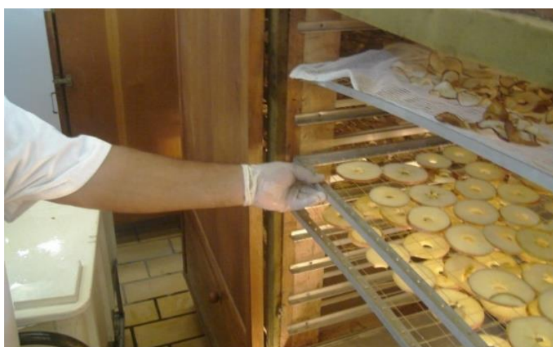
Figura 4: Colocação de maçãs no desidratador de frutas. Foto: Patrick Camporez Mação. Fonte: CORNEJO; NOGUEIRA; WILBERG, 2022.
