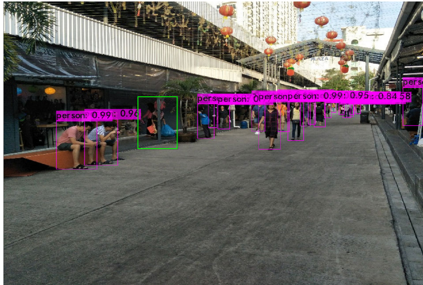
Figura 4.13 – Imagem de exemplo mostrando as predições realizadas pela rede padrão do YOLOv3 e a marcação de um falso negativo (em verde)
