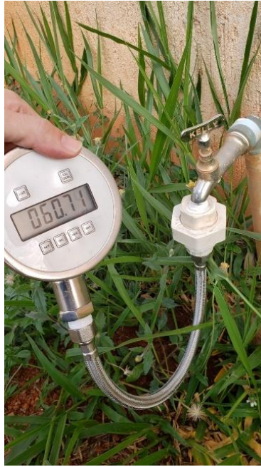
Figura 5.1 Pressão da torneira de jardim externa do BSAS – Leitura 1.
