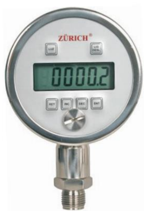
Figura 4.6 Manômetro Registrador (Fonte: ZURICH - Manual Z.10.)
