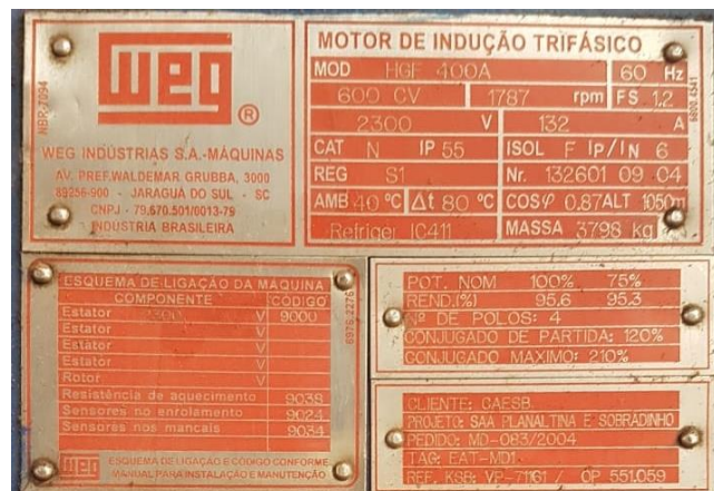
Figura 4.8 – Placa do motor da bomba
