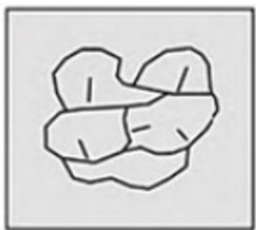
Figura 11: Fissuras devido à retração por secagem em laje de concreto
