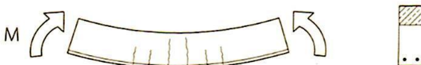
Figura 18: Representação das fissuras ocorridas por flexão pura
