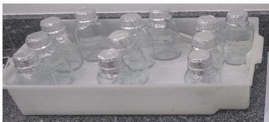
Figura 10. Garrafas impregnadas com a amostra para realização do teste de toxicidade.
