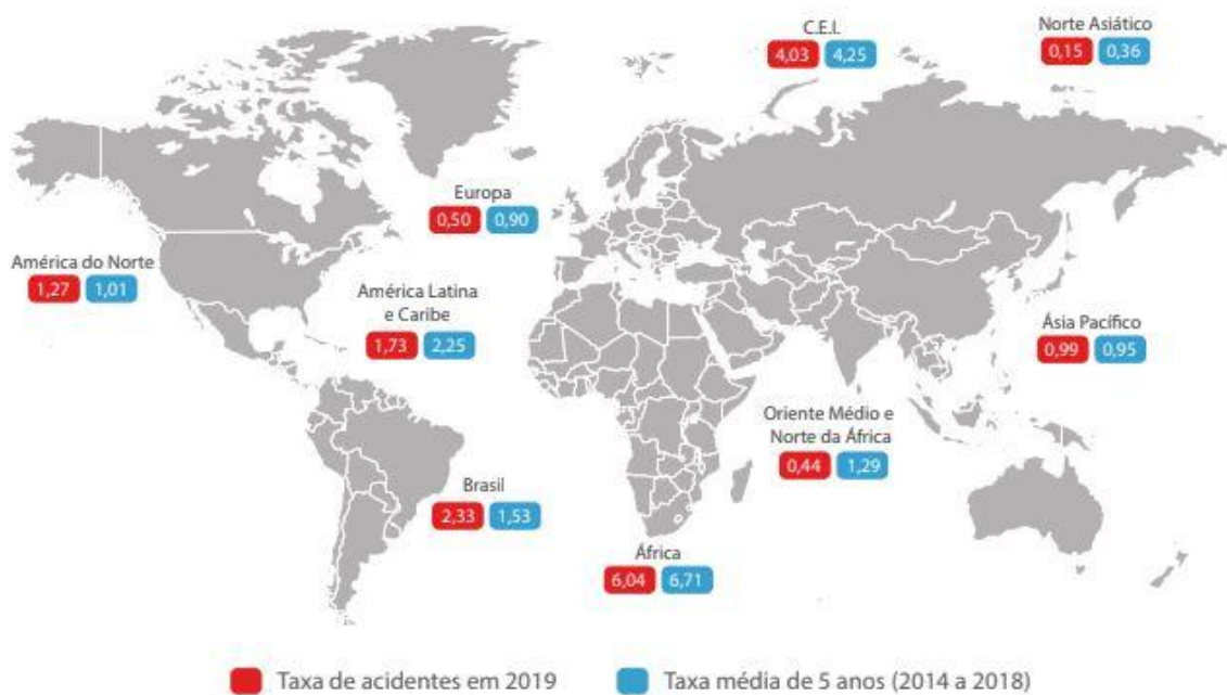
Figura 1.1: Taxa de acidentes totais (acidentes por milhão de decolagens) em 2019 e taxa média entre 2014 e 2018 para diferentes regiões, conforme classificação da IATA. Fonte: CENIPA e IATA.
