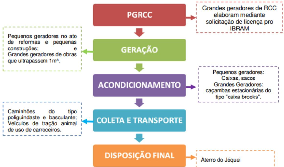
Figura 2.7 – Fluxograma do manejo de RCC Fonte: PDGIRS (2018)
