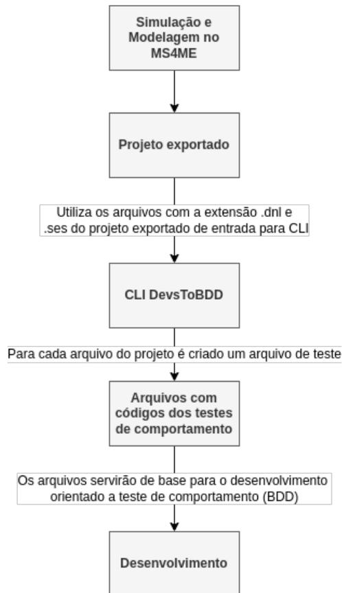
Figura 3.1: Visão geral do processo de desenvolvimento com a CLI
