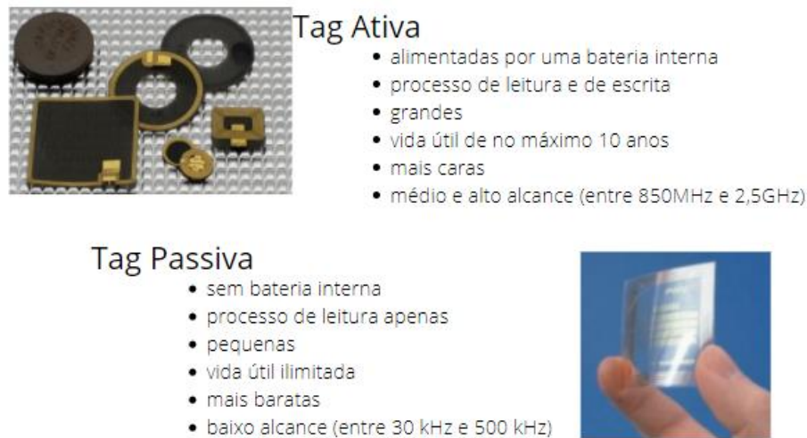
Figura 9: Comparativo entre tag ativa e passiva no RFID
