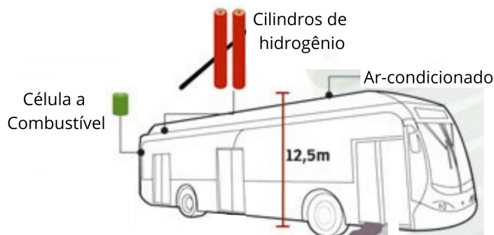
Figura 17 – Corte de um veículo a célula combustível - Ônibus
