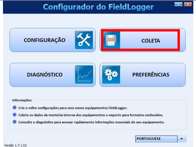
2º Passo: Exportação dos dados solarimétricos através do software Fieldlogger Novus.
