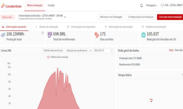
3º Passo: Coleta dos dados de geração através da plataforma da Canadian.
