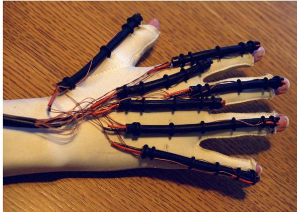
Figura 5 – Sayre Glove, um dos primeiros projetos de luva eletrônica com sensores acoplados . Fonte: [3].
