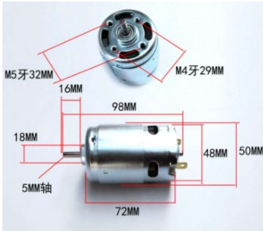
Figura 3.6 – Principais medidas do motor MACHIFIT 895
