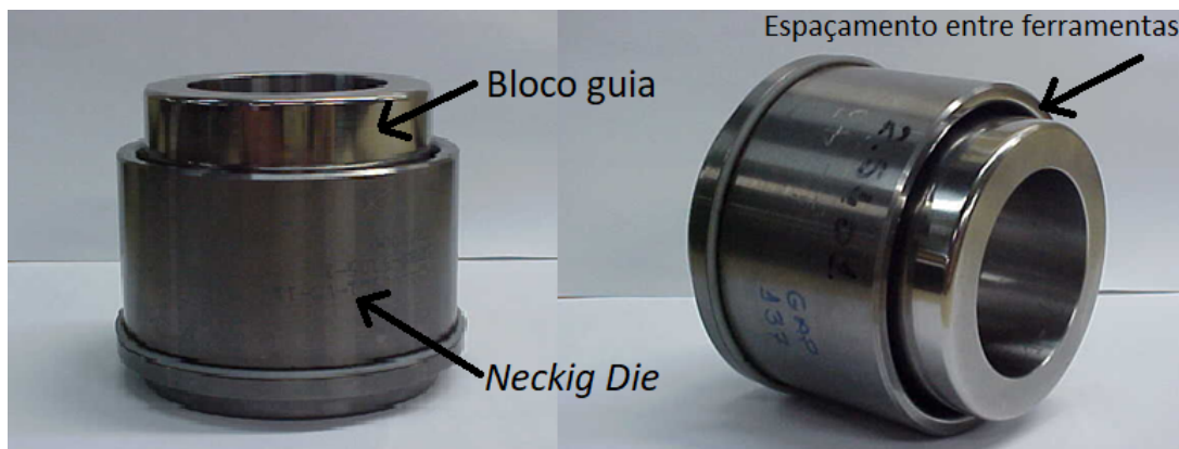
Figura 13 – Ferramentas de conformação do pescoço, Necking Die e Bloco guia. Fonte: Autora (sob autorização da empresa fabricante.)
