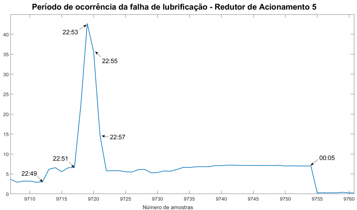
Figura 39 – Período de ocorrência de falha de lubrificação. Fonte: Autora (sob autorização da empresa fabricante.)
