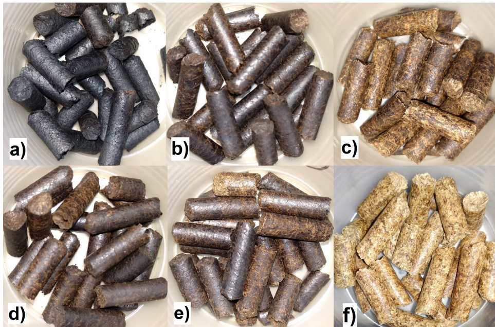
Figura 46 – Péletes obtidos após a) Ensaio 1; b) Ensaio 2; c) Ensaio 3; d) Ensaio 4; e) Ensaio 5 em comparação com os péletes f) in natura
