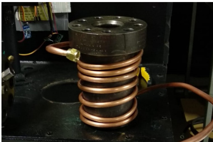
Figura 30 – Montagem da estrutura para aproveitamento de calor do reator na entrada de gases.
