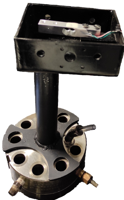
Figura 27 – Estrutura posicionada no reator.
