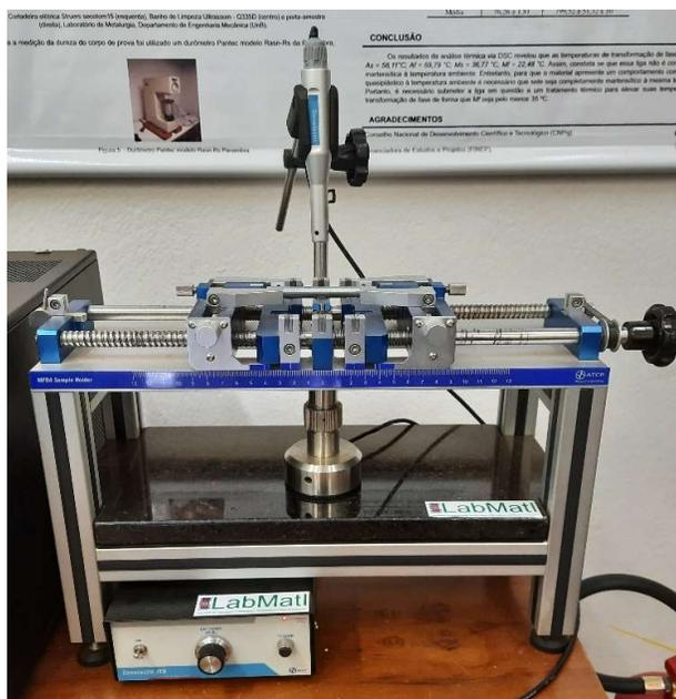
Figura 3.6 - Equipamento Sonelastic desenvolvido pela ATCP Engenharia Física para medição dos módulos elásticos através do método de excitação por impulso.
