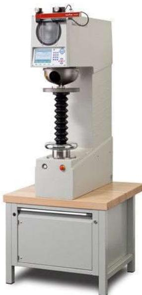
Figura 3.9 - Durômetro universal modelo ZHU250 da Zwick/Roell (Disponível em: [www.directindustry.com/pt/prod/zwickroell-gmbh-co-kg/product-15660-1100157.html](http://www.directindustry.com/pt/prod/zwickroell-gmbh-co-kg/product-15660-1100157.html). Acesso em: abril 2021).
