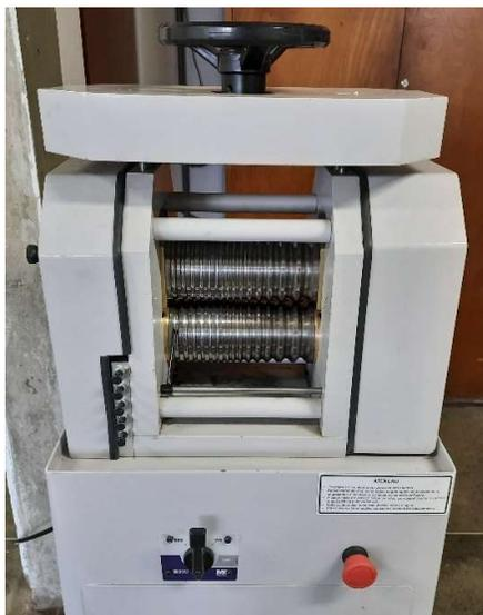
Figura 3.4 - Laminador elétrico da marca Máquinas Coelho na configuração duo.
