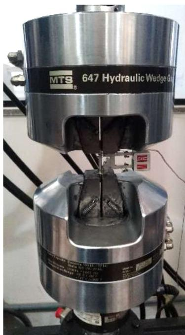
Figura 3.8 - Equipamento de ensaio de tração com extensômetro (Maranhão, 2019).
