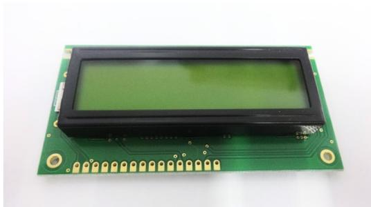
Figura 10 – Display LCD 16x2
