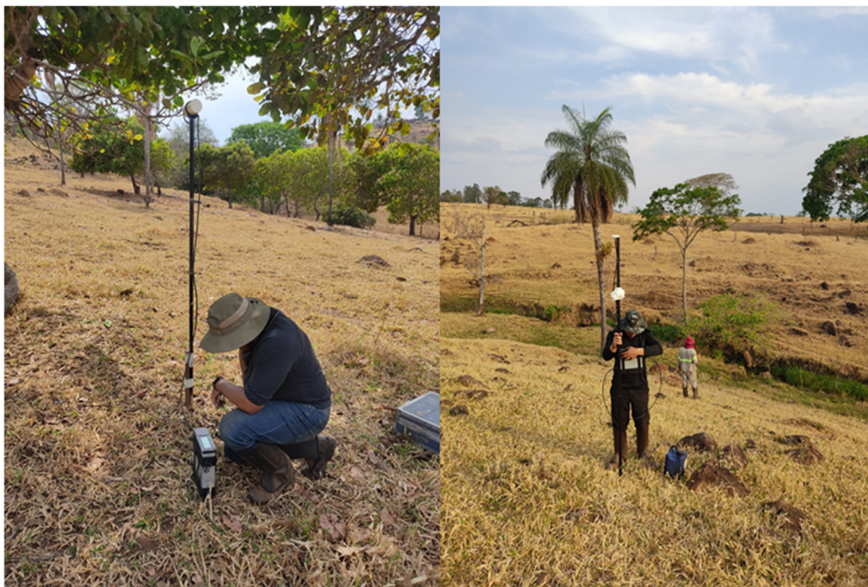
Figura 4-2 Fotografias evidenciam a aquisição de dados de magnetometria terrestre com o magnetômetro GSM19 na área de pesquisa.
