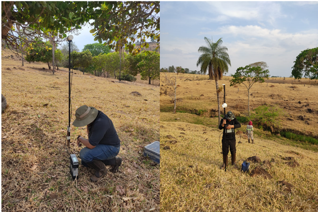
Figura 5-4 Fotografias evidenciam a aquisição de dados de magnetometria terrestre com o magnetômetro GSM19 na área de pesquisa.
