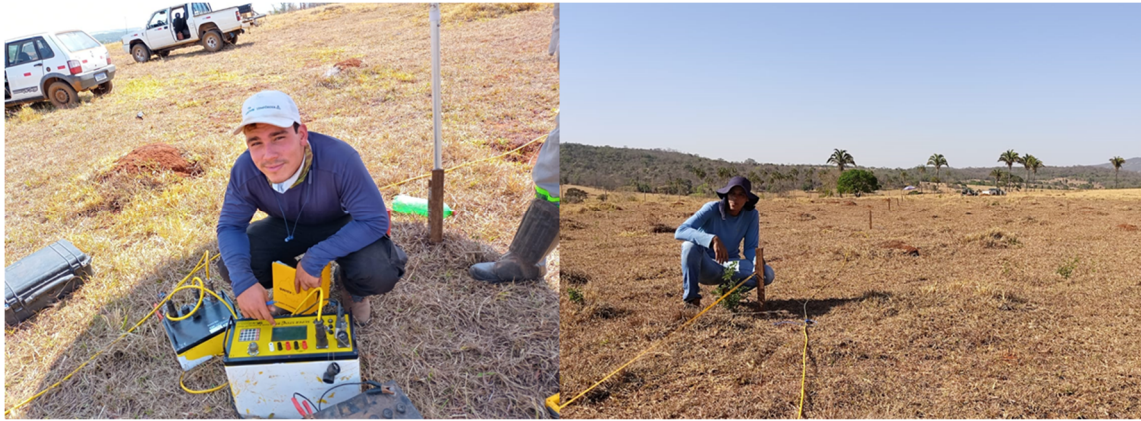
Figura 4-1 Fotografias evidenciam a aquisição de dados de resistividade elétrica efetuados com o equipamento SuperSting R8 na área da pesquisa.
