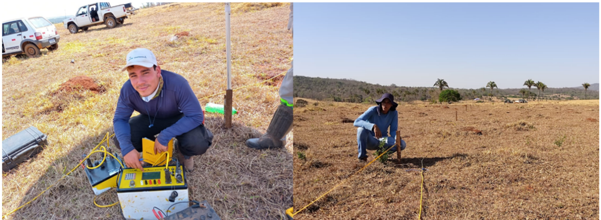
Figura 5-3 Fotografias evidenciam a aquisição de dados de resistividade elétrica efetuados com o equipamento SuperSting R8 na área da pesquisa.
