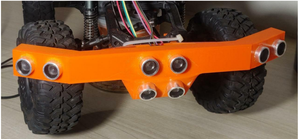
Figura 53: Instalação física do sensor ultrassônico de proximidade.
