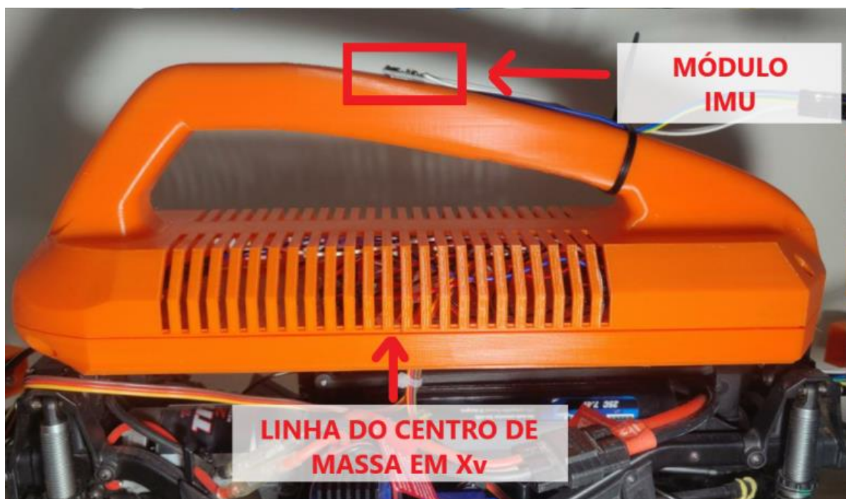
Figura 64 Sensor IMU instalado no Centro de massa do veículo referente aos eixos cartesianos X_v e Y_v no exterior para não sofrer influência dos motores.
