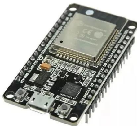
Figura 36. Imagem da placa controladora “DOIT ESP32 DEVKIT V1”
