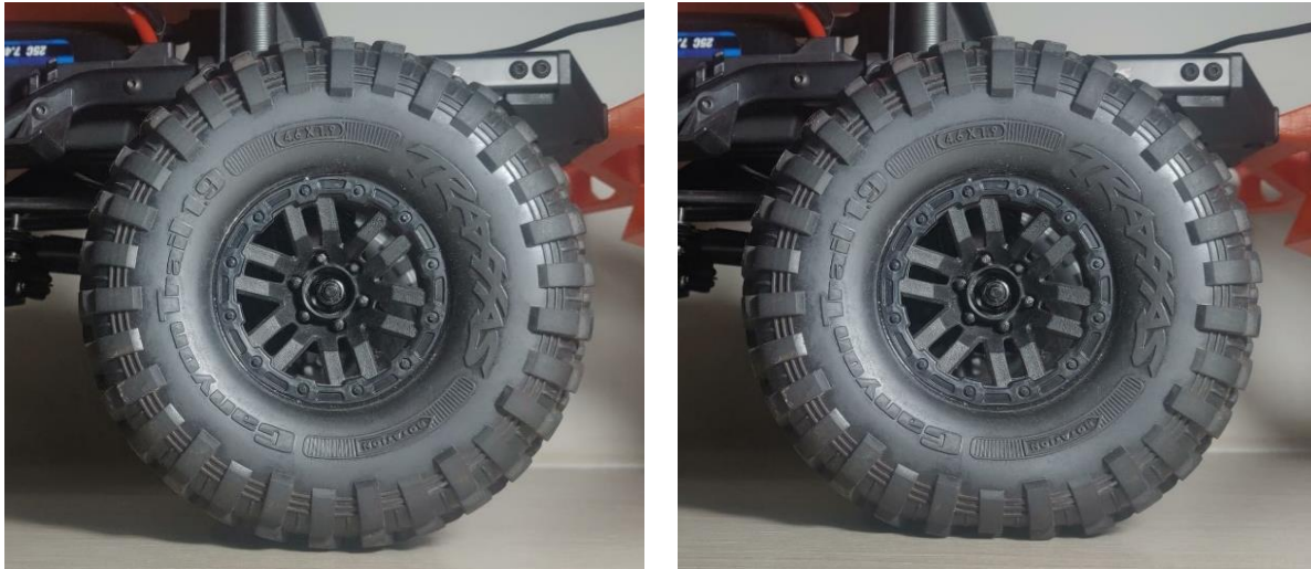
Figura 60. Comparação de roda do automodelo sem estar recebendo a carga do peso do veículo (na esquerda) e após receber o peso do veículo (na direita).
