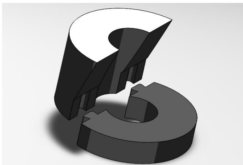
Figura 51. Peça cilíndrica do sensor de leitura de velocidade.
