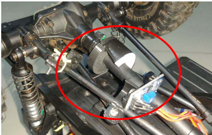
Figura 52. Sensor infravermelho com peça cilíndrica de duas cores para auxiliar a medição.
