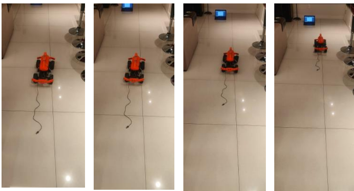
Figura 69. Teste de guiagem em linha reta com correção por PID.
