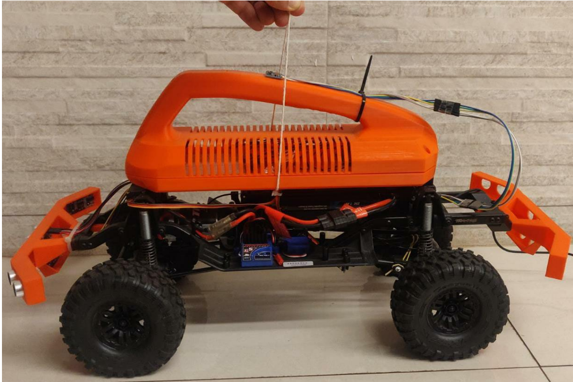
Figura 58. Procedimento para se descobrir o centro de massa longitudinal.
