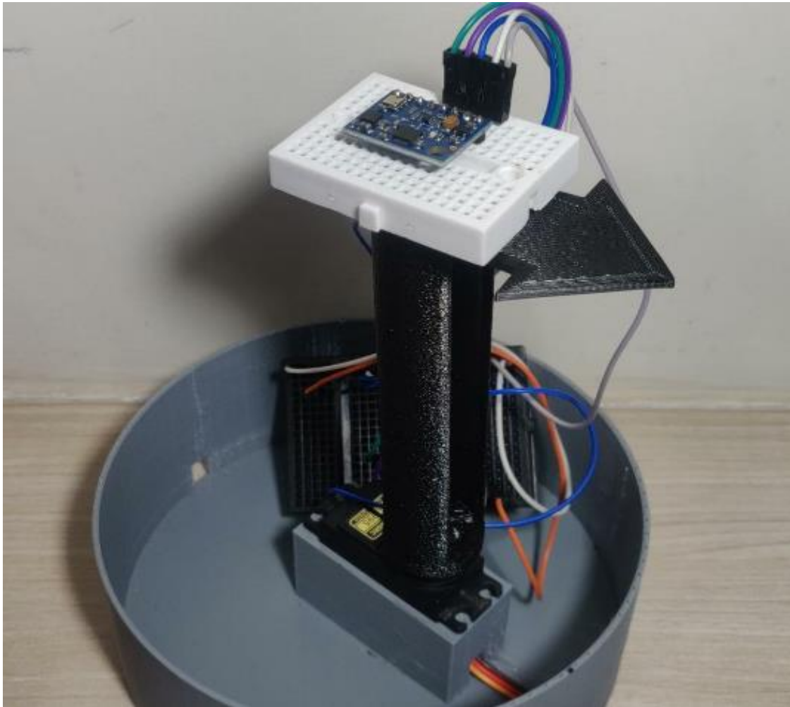
Figura 62. Plataforma de teste Giroscópio Vs. Magnetômetro, impressa para afastar o sensor do servo com o intuito de impedi-lo de sofrer interferências de leitura.
