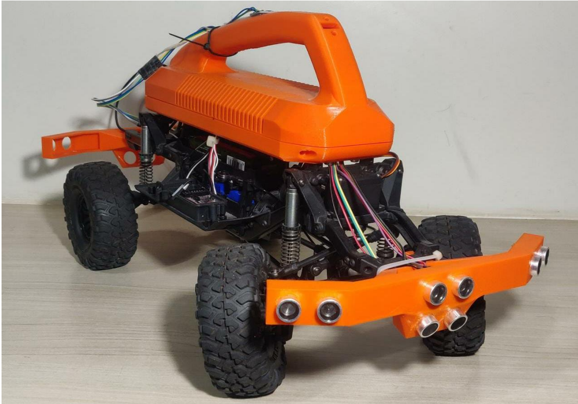
Figura 50. Foto do suporte montado no automodelo.
