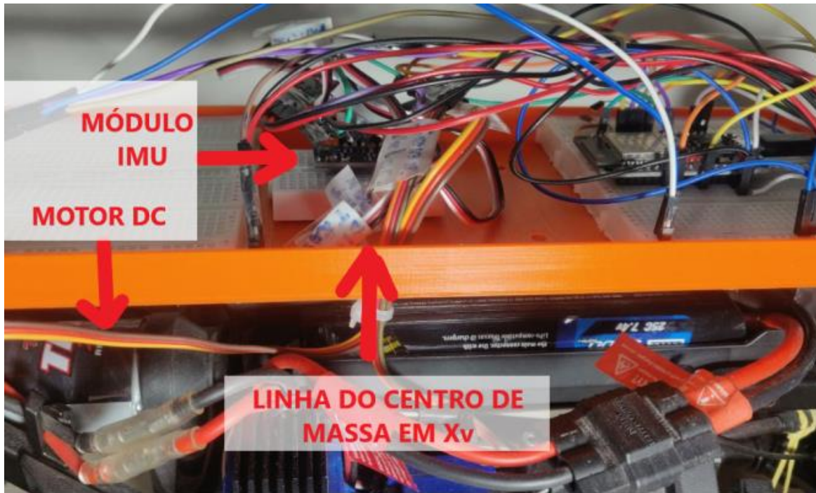
Figura 63. Sensor IMU instalado no Centro de massa do veículo referente aos eixos cartesianos X_v e Y_v no interior do suporte de plástico.
