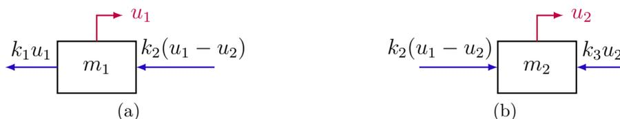
Figura 11 – DCLs de um sistema linear: (a) corpo da esquerda e (b) corpo da direita.
