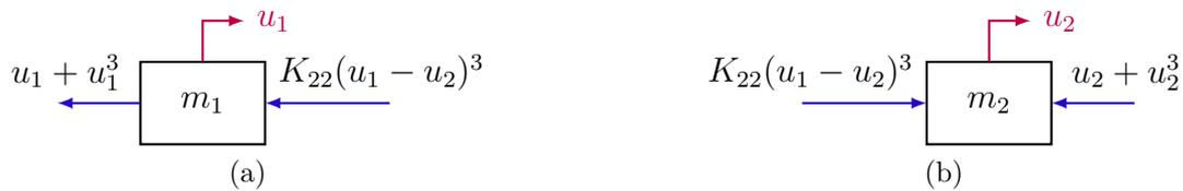
Figura 14 – DCLs de um sistema não-linear: (a) corpo da esquerda e (b) corpo da direita.
