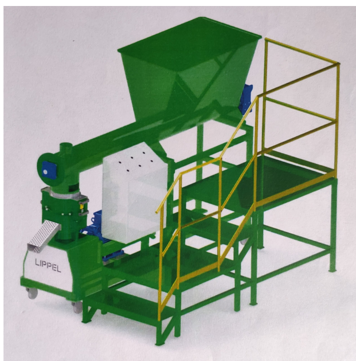
Figura 27 – Renderização 3D da Peletizadora BEP-200 (LIPPEL, 2016)
