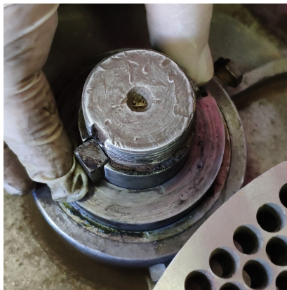
(a) Posicionamento das chavetas sobre o eixo.
