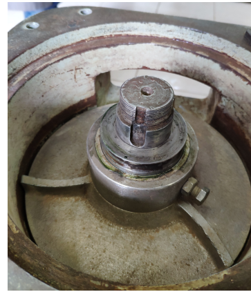
(b) Disco fatiador posicionado sobre o eixo, abaixo da matriz.
