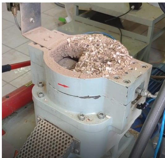
Figura 41 – Biomassa transbordando câmara de peletização após realização do teste diagnóstico.
