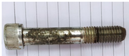
Figura 54 – Parafuso M12, classe de resistência 8.8, utilizado para fixação da carcaça.
