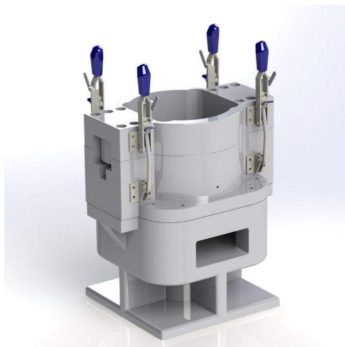
Figura 56 – Grampos KF-153DTR posicionados nas laterais da carcaça.
