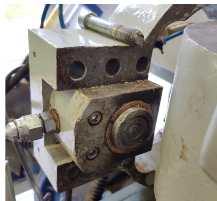
(b) Pistão hidráulico presente na tampa da carcaça.
