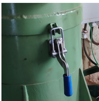
Figura 52 – Grampo de pressão para fixação da carcaça presente em peletizadora da ENG-MAQ.
