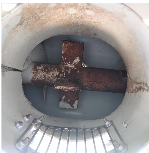
(b) Mecanismo de direcionamento da biomassa presente no eixo helicoidal.
