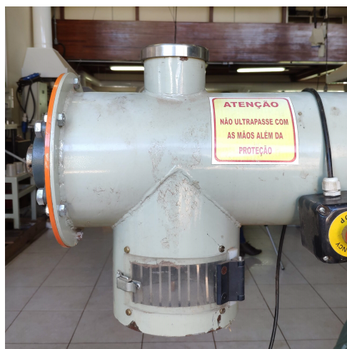
(a) Bocal de saída e chaminé.
