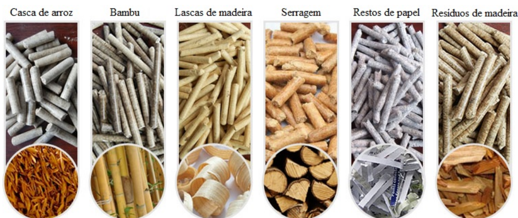
Figura 7 – Exemplos de pellets produzidos a partir de diferentes fontes de biomassa. (ABC Machinery, 2020)
