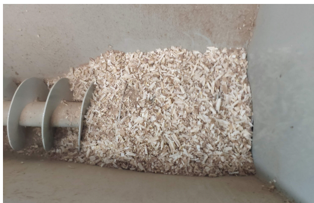
Figura 40 – Amostra de biomassa depositada no silo de alimentação.
