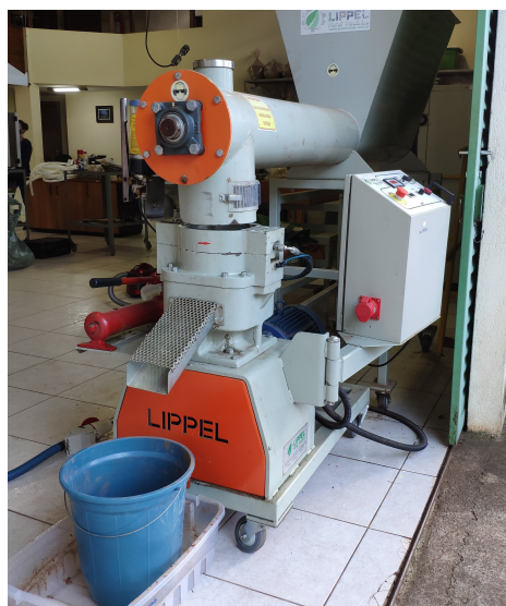
Figura 31 – Módulo do sistema de peletização, posicionado abaixo do transportador helicoidal.
