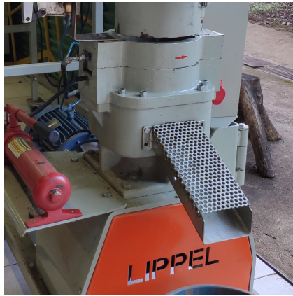
(a) Detalhe do bocal de saída de pellets na carcaça inferior.
