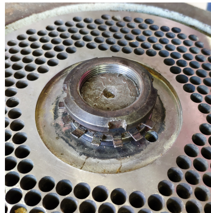
(b) Porca sobre a ponta rosqueada do eixo.
