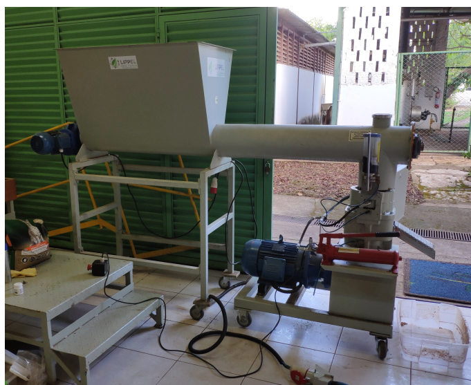
Figura 28 – Módulo de alimentação da Peletizadora BEP-200, posicionado sobre o módulo de peletização.
