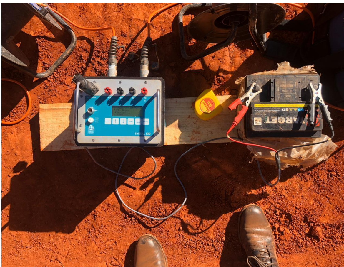
Figura 5. 2 - Resistivímetro Syscal Kid, fabricado pela francesa Iris Instruments.
