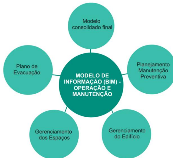
Figura 4.11: Diagrama dos usos do BIM para operação e manutenção. Fonte: AsBEA (2015a).
