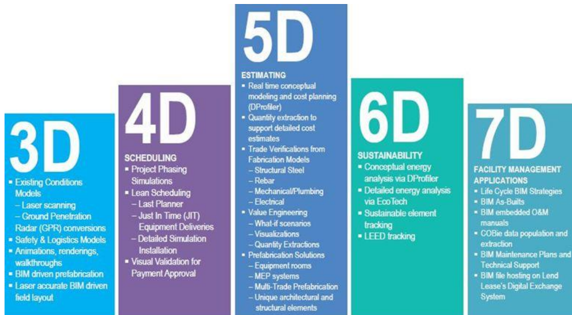
Figura 4.7: Dimensões dos modelos BIM. Fonte: Hastagbim (2015)
