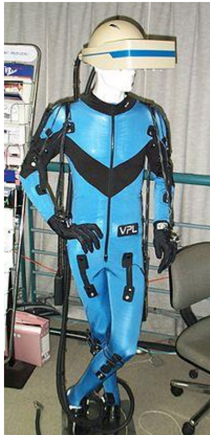
Figura 4.23: DataSuit feito pela VPL Research. Fonte: Pape (1999).
