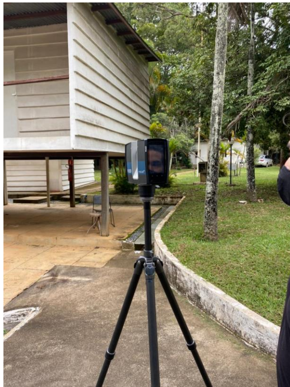
Figura 5-9: Laser Scanner FARO Focus M 70 em uso
