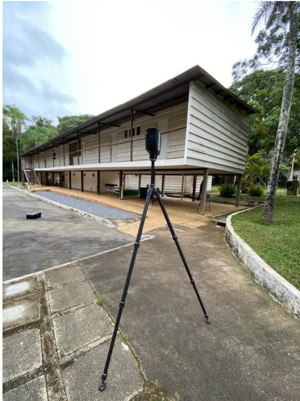
Figura 5-8: Laser Scanner FARO Focus M 70 em uso
