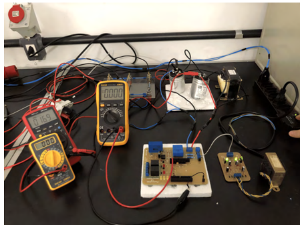
Figura 39 – Foto do ensaio de caracterização do circuito de condicionamento de tensão para condição inicial, ou seja, para um sinal de 0V .
