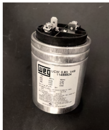
Figura 37 – Foto do filtro LC utilizado nos ensaios experimentais, tal que o indutor é de 1,5\text{mH}/20\text{A} e o capacitor é de 11,4\mu\text{F}/440\text{V} .
