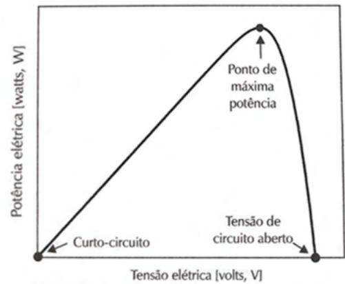
Figura 9 – Curva característica P - V (potência - tensão) dos painéis solares. (VILLALVA, 2015)
