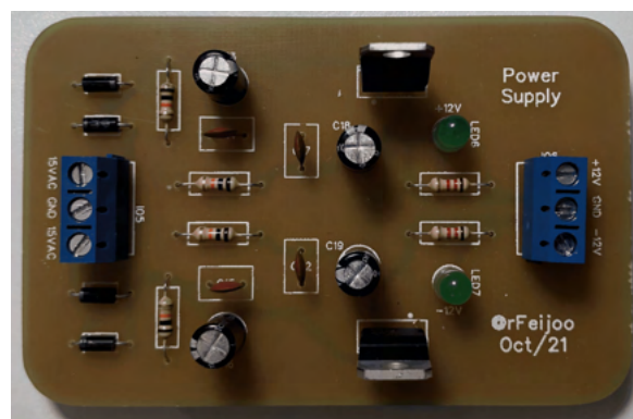
(b) Foto da placa de circuito impresso com a fonte de alimentação montada.
