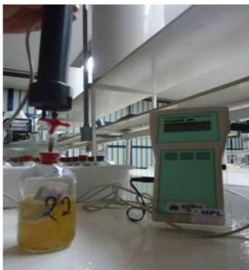
Figura 8 - Sistema de leitura da pressão dos gases acumulados nas garrafas.
