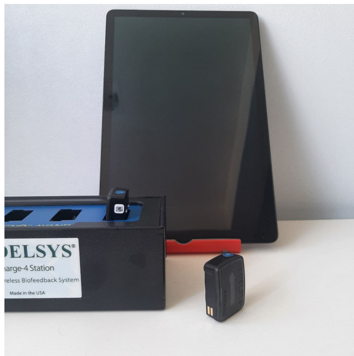
Figura 3.1: Equipamentos para aquisição de dados da Delsys Inc. Os equipamentos incluem base de carga, dois sensores e um tablet com aplicações móveis para uso dos sensores.
