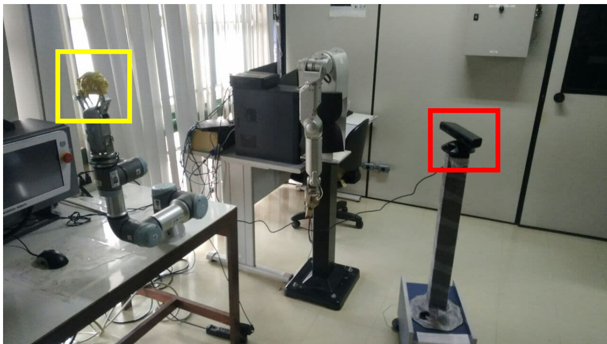
Figura 3.11: Posicionamento de uma câmera para fazer o rastreamento da posição do efetuador terminal para efeitos demonstrativos
