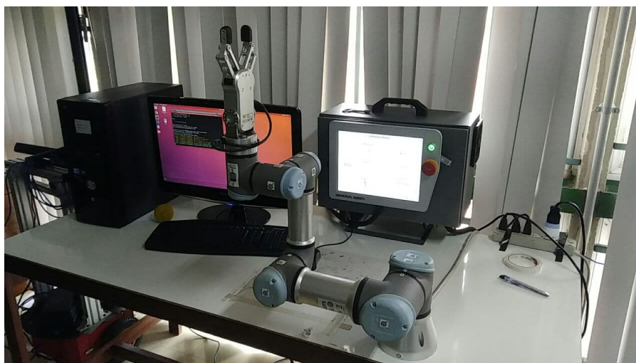
Figura 3.10: Posicionamento do UR3 com a configuração gerada com as posições das juntas a partir dos valores \theta_{inicial} da tabela 3.2
