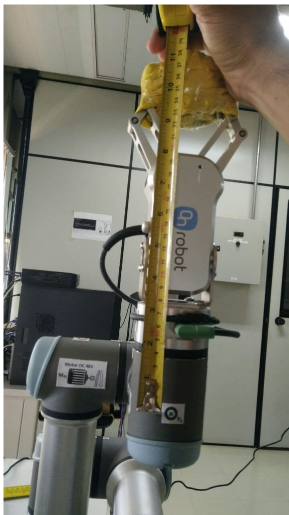
Figura 3.17: Verificação da distância d_6 usando uma fita métrica
