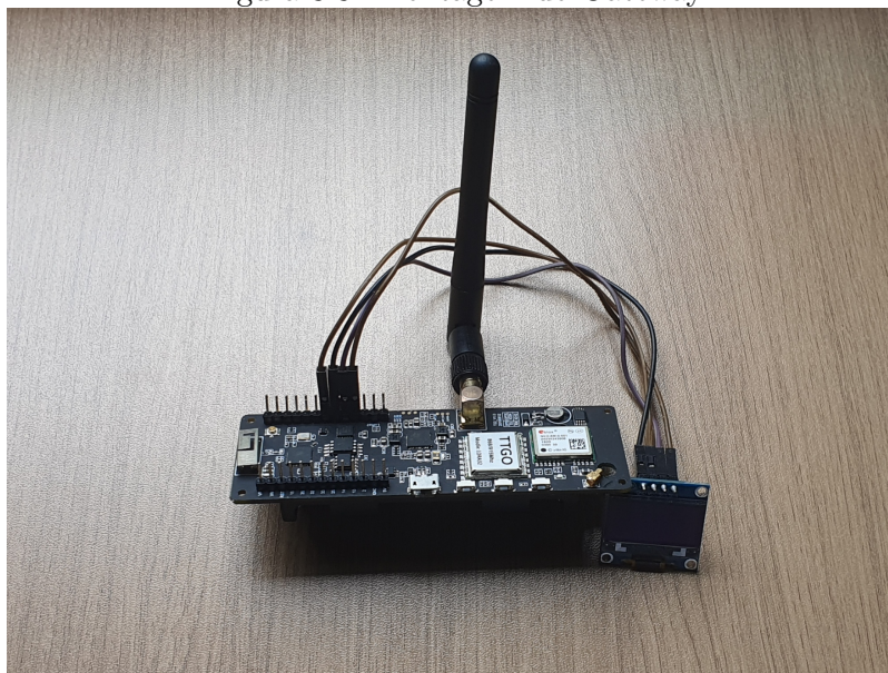
Figura 3.8: Montagem do Gateway.
