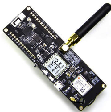
Figura 3.1: Placa LILYGO TTGO T-Beam Versão 1.0.
