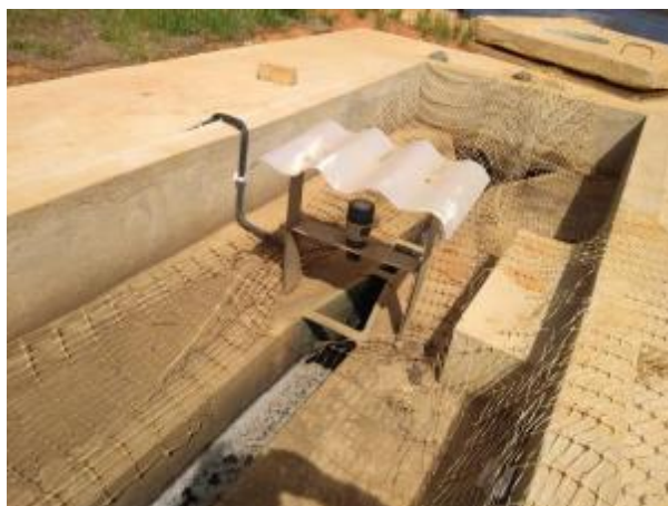
Figura 2.31 - Calha Parshall utilizada no ASB (Jucá e Fernandes, 2020)
