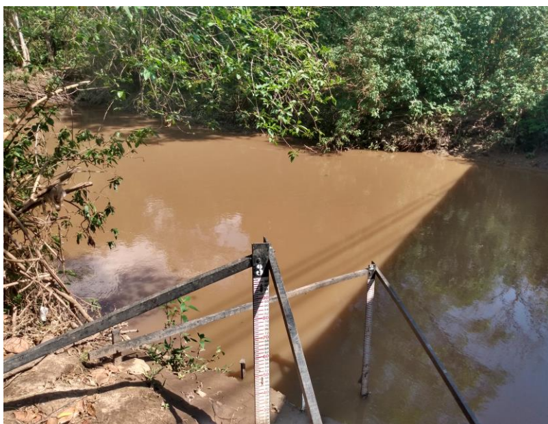
Figura 29- Réguas instaladas às margens do córrego Riacho Fundo.
