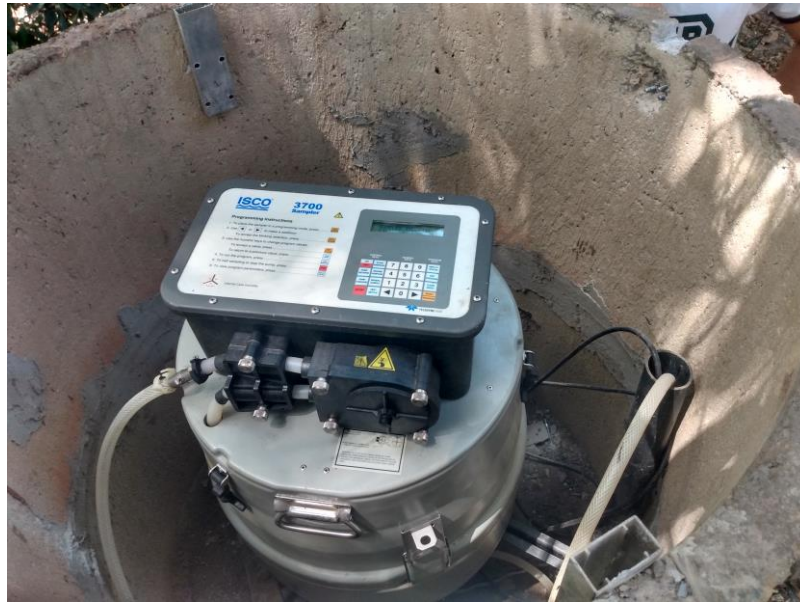
Figura 30- Amostrador instalado na estação fluviométrica Ponte Aeroporto, próximo a margem do córrego Riacho Fundo.
