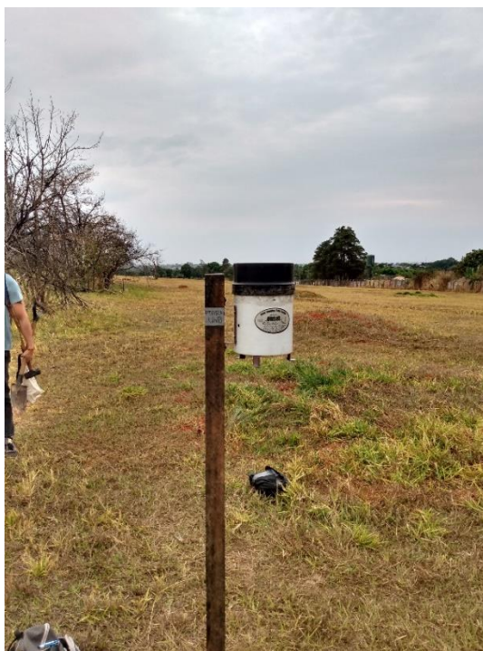
Figura 32- Pluviógrafo instalado no parque de Águas Claras.
