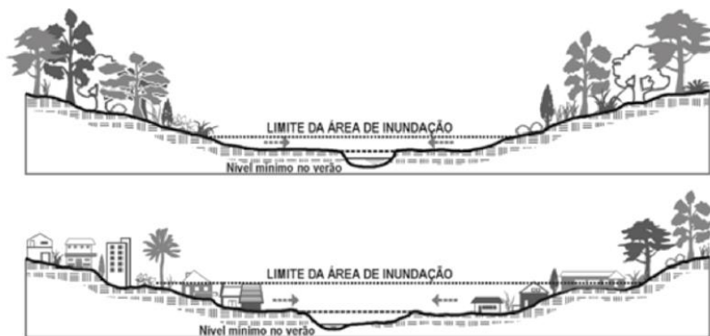
Figura 3- Consequência da impermeabilidade e área de inundação (Schueler, 1987 apud Tucci, 2005).
